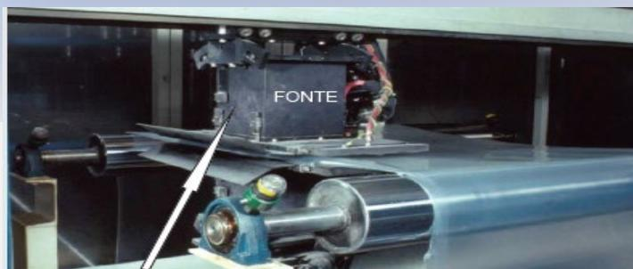
Um medidor de espessura com uma fonte de beta incorporada. Na foto, a fonte radioativa está contida na carcaça acima do produto que está sendo medido e o detector está no lado oposto.
